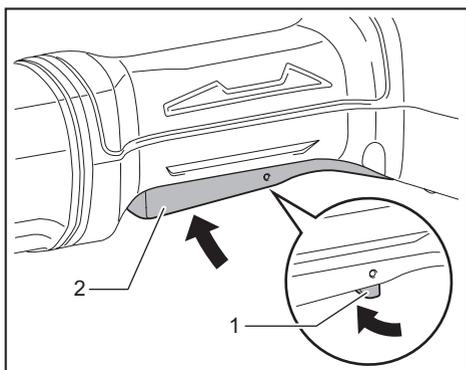
► 1. Palanca de desbloqueo 2. Interruptor de palanca
